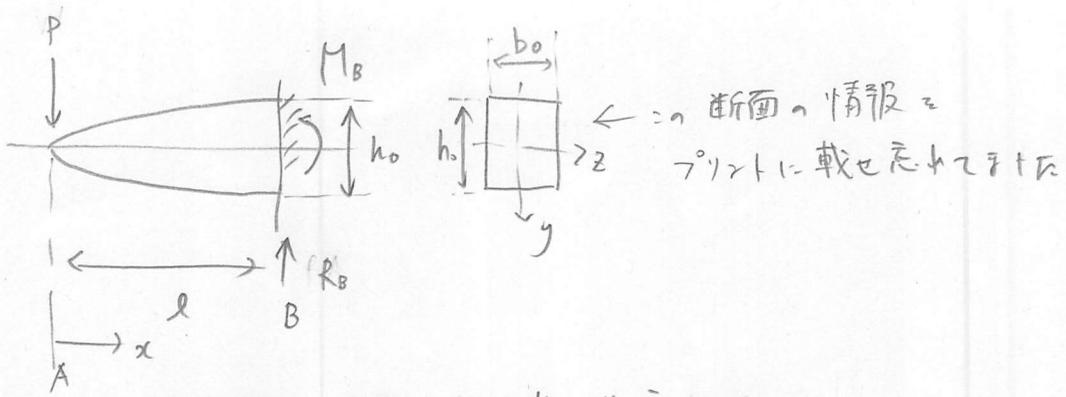
はりの上下面に発生する曲げ応力  $\sigma$  は
