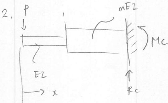
C での反力  $R_c$ 、反時計回りの  $M_c$  とする
